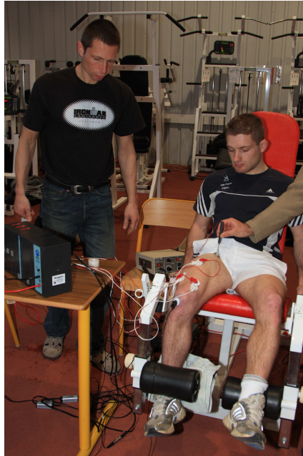
Figure 24 a. - Ergomètre "genou" : la force musculaire était évaluée à l'aide d'une jauge de contrainte (sensibilité: 1,993 mV/V et 0,0049 V/N ; SBB 200 kg, Allegro, Sallanches, France) reliée à une machine à quadriceps (Multi-form, la Roque d'Anthéron, France). Les sujets sont assis (angle de la hanche = 90°, angle au niveau du genou = 80°).
